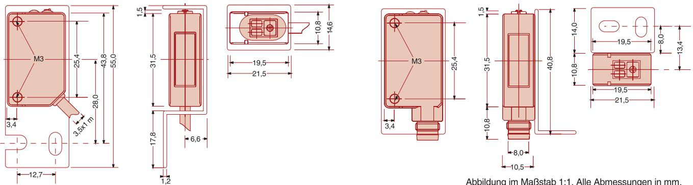
Abbildung im Maßstab 1:1. Alle Abmessungen in mm.
